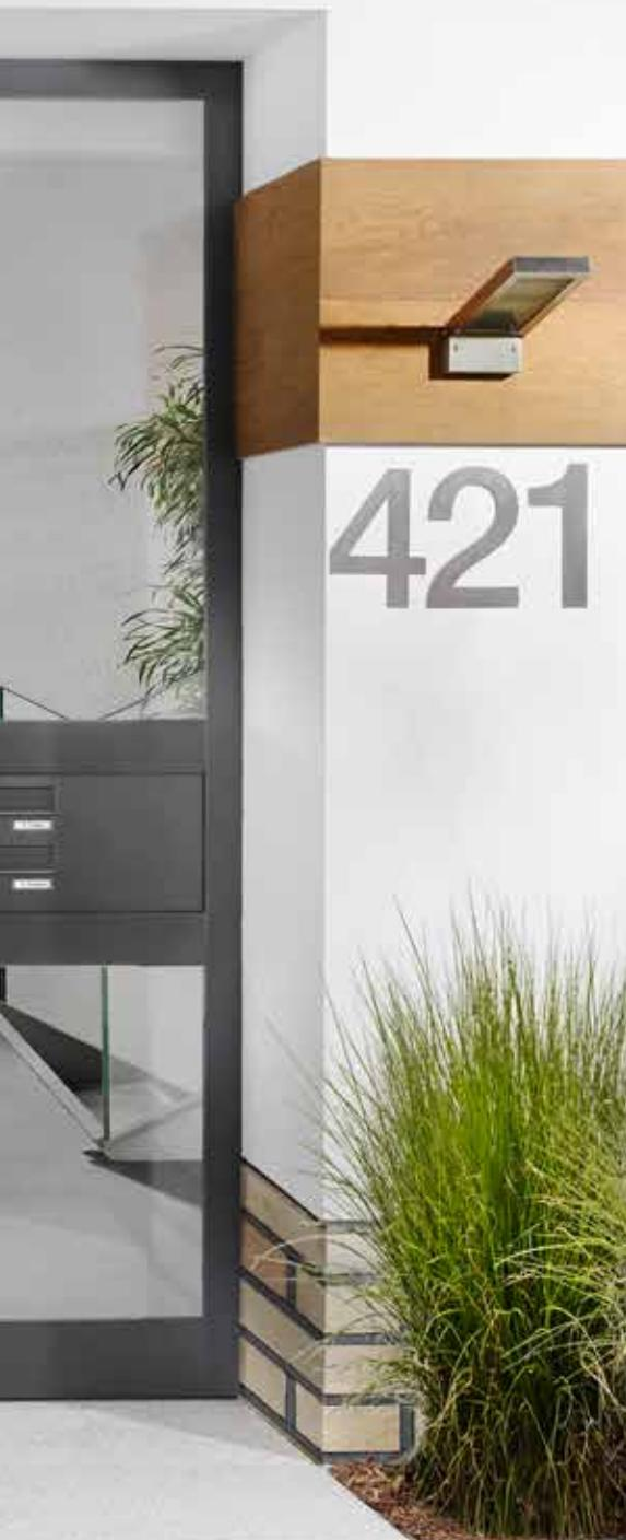
Naše presklené domové dvere TopComfort vám vytvoria svetlý a priateľský vstup do domu so solídnym vybavením. Dvere presviedčajú hliníkovým profilom dverí s hrúbkou 80 mm a s termicky oddeleným hliníkovým rámom dverí s hrúbkou 80 mm a vykazujú tak dobrú tepelnú izoláciu s hodnotou  $U_D$  do cca 1,3 W/(m<sup>2</sup>·K). Sériový, 5-násobný bezpečnostný zámok vám poskytne istotu, ktorú očakávate od domových dverí. Takto bude vstup do domu nielen vokusne vyzerat, ale bude aj bezpečný.
